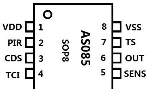
人体热释红外线感应控制 IC（灵敏度可调、延时时间可调、光敏可调）
