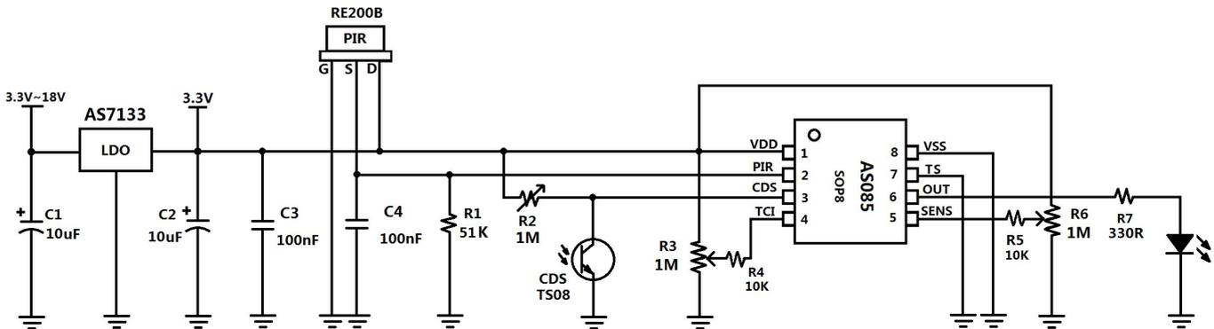
TS 接 VSS 时，R4 调整控制信号输出延时时间（无段调节）
