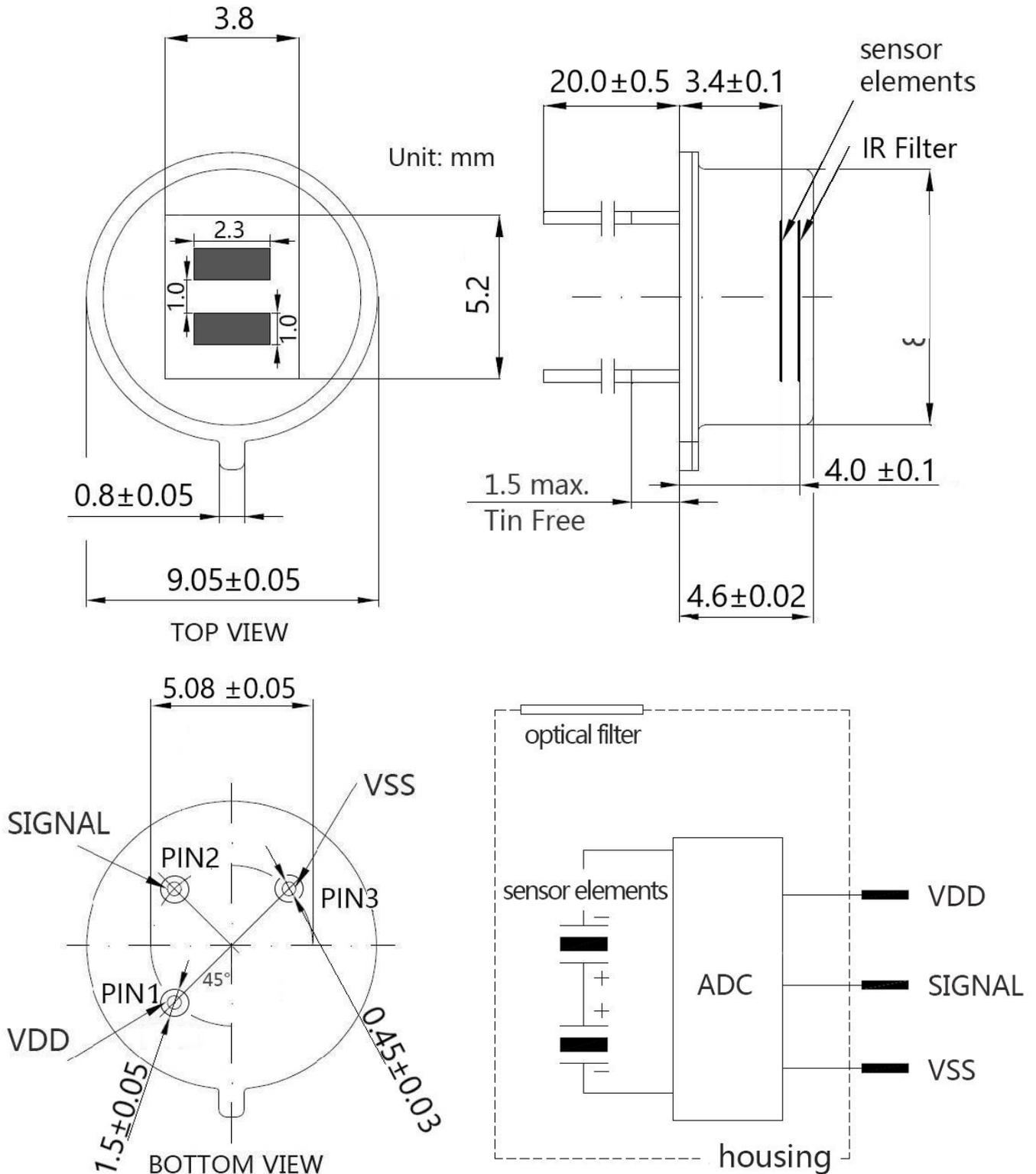
人体热释电红外传感器 (Pyroelectric Infrared Sensor)
